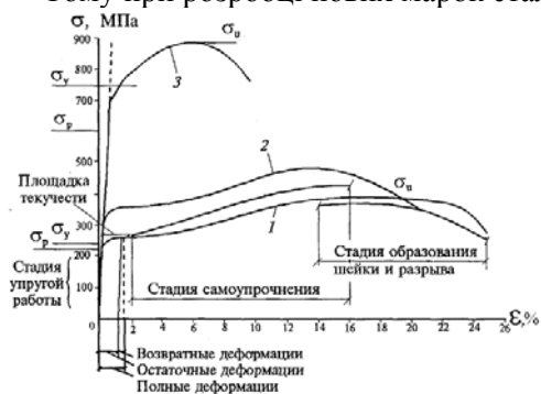
Рис. 1 Діаграма розтягування сталей 1 ВСт3сп; 2 09Г2С; 3 високоміцні сталі
