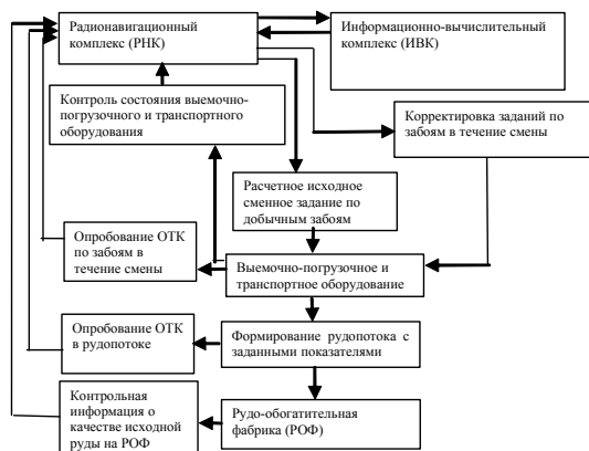
Рис. 4. Структурная схема комплексной системы контроля и управления качеством в рудопотоках карьеров
