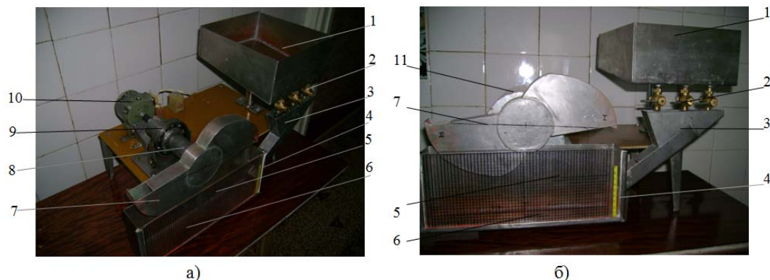
Рис. 2 Физическая модель улиткового питателя без кожуха (а) и в плане относительно улитки (б) 1 – емкость с жидкостью; 2 – средства регулирования расхода жидкости; 3 – песковый желоб; 4 – приемное устройство; 5 – прозрачная стенка со шкалой; 6 – жидкость; 7 – улитка с двумя захватными элементами; 8 – ось вращения улитки; 9 – шариковый подшипник; 10 – электродвигатель; 11 –
