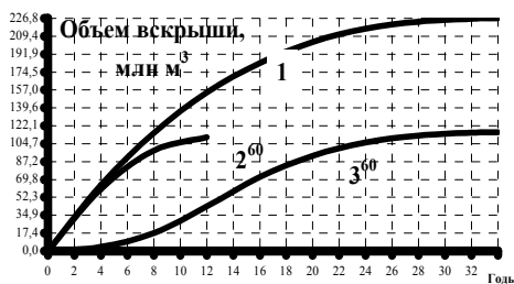
Рис. 3. Динамика объемов вскрышных пород при внешнем отвалообразовании (1) и комбинированном с высотой яруса внутреннего отвала 60 м: 2 60 – на внутренний отвал; 3 60 – на внешние отвалы
