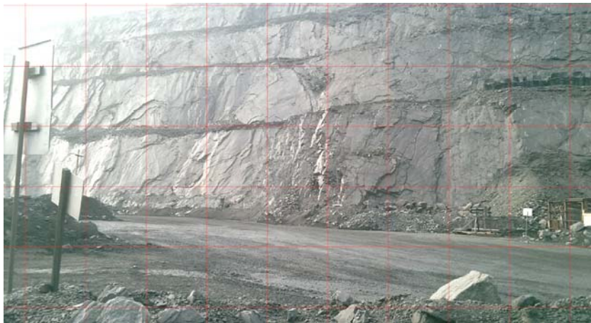
Рис. 2. Спаренные уступы на западном борту карьера ИнГОКа, поставленные в предельное положение по напластованию ( \delta = 8 )
